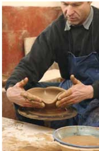
Von Hand formt er aus dem runden Schüsselrand vier Seiten.
