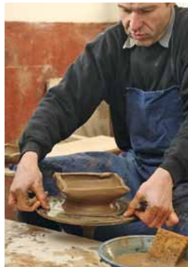
Kachel von der Scheibe lösen und trocknen. Später wird sie gebrannt.
